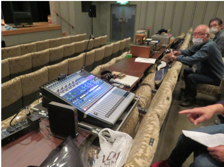
手前がウクライナ支援コンサート用の PA 調整卓、奥が作品発表用の送り出し装置
